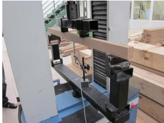
Fig. 4 Ensayo de vigas dúo MDF de acuerdo a UNE EN-408.
