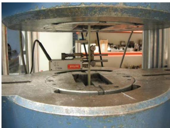
Fig. 3 Ensayo a tracción acorde con ISO 527-5 de las bandas rígidas GFRP.
