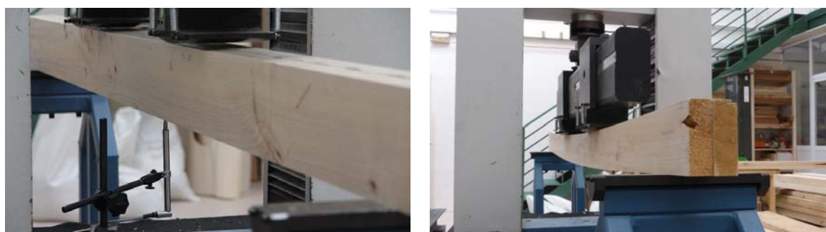
Fig. 6 Ensayo de vigas dúo de acuerdo a UNE EN-408.
