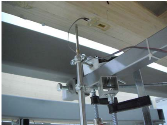
Fig. 9 Monitorización y puesta en carga de los ensayos de fluencia.
