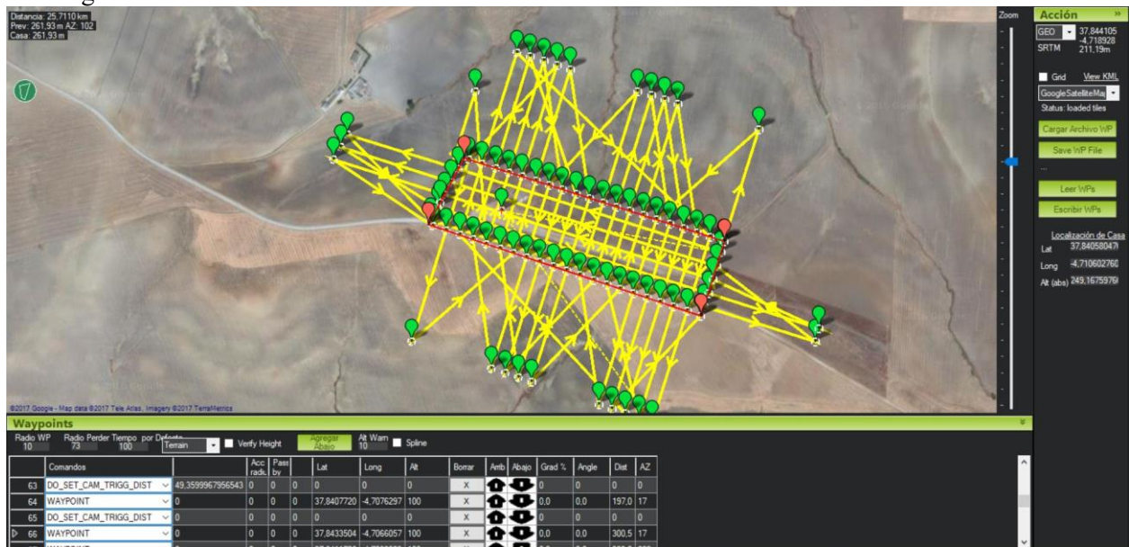
Ilustración 9: planificación de la misión con el software Mission Planner
