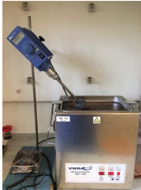
Figura 50. Baño de agua con ultrasonido y agarre para rotación Ultrasonics Cleaner USC-THD .
