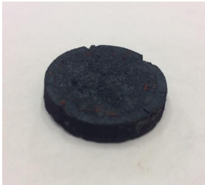
Figura 58. Fotografía de una muestra Fe 2 O 3 / NiO tras la sublimación completa del canfeno.
