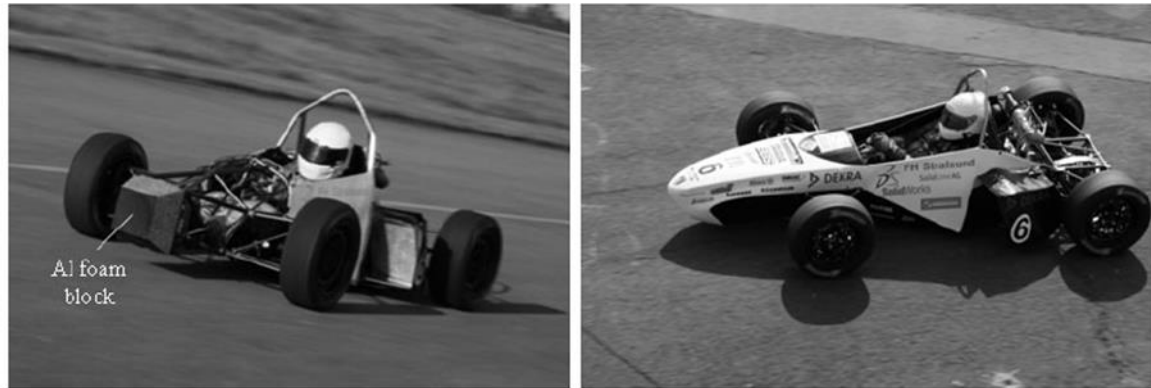
Figura 3. Elemento protector contra choques en un coche de carreras fabricado por la Universidad Tecnológica de Stralsund, Alemania. [LEF 2008]
