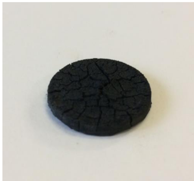
Figura 60. Fotografía de una muestra Fe-Ni tras el ciclo de sinterización-reducción.
