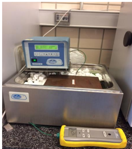
Figura 54. Placa de cobre en baño de agua con un termostato de inmersión digital DIGITERM 200 .
