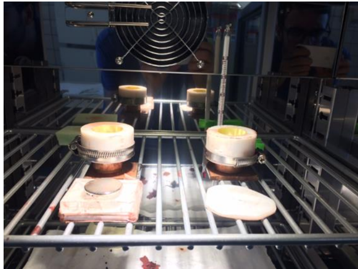
Figura 52. Moldes en la incubadora a 60 °C previamente al vertido de la suspensión.
