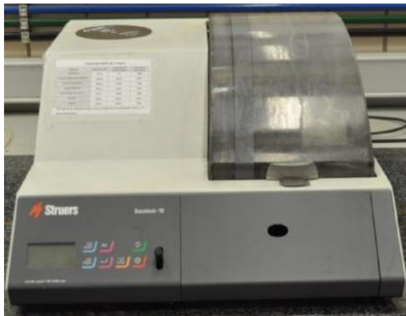
Figura 65. Cortadora de precisión Secotom-10 (Stress) .
