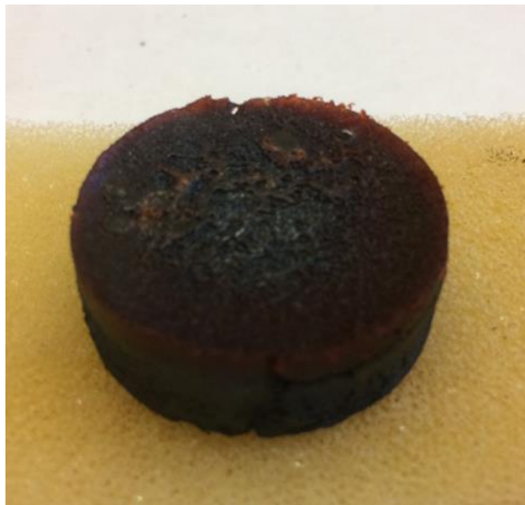
Figura 55. Fotografía de una muestra Fe 2 O 3 / NiO tras desmoldarla, justo antes de que comience la sublimación.
