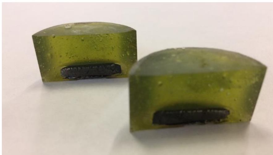
Figura 63. Fotografía de una muestra empastillada y con un corte central.
