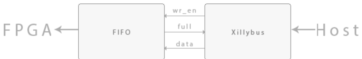
Figura 4-2. Flujo de datos con FIFO en dirección Host-FPGA
