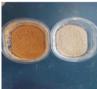
Fig.V.4. Imagen de los gránulos obtenidos en los ensayos con la CTI-Fe y la CTI-HDTMA respectivamente.
