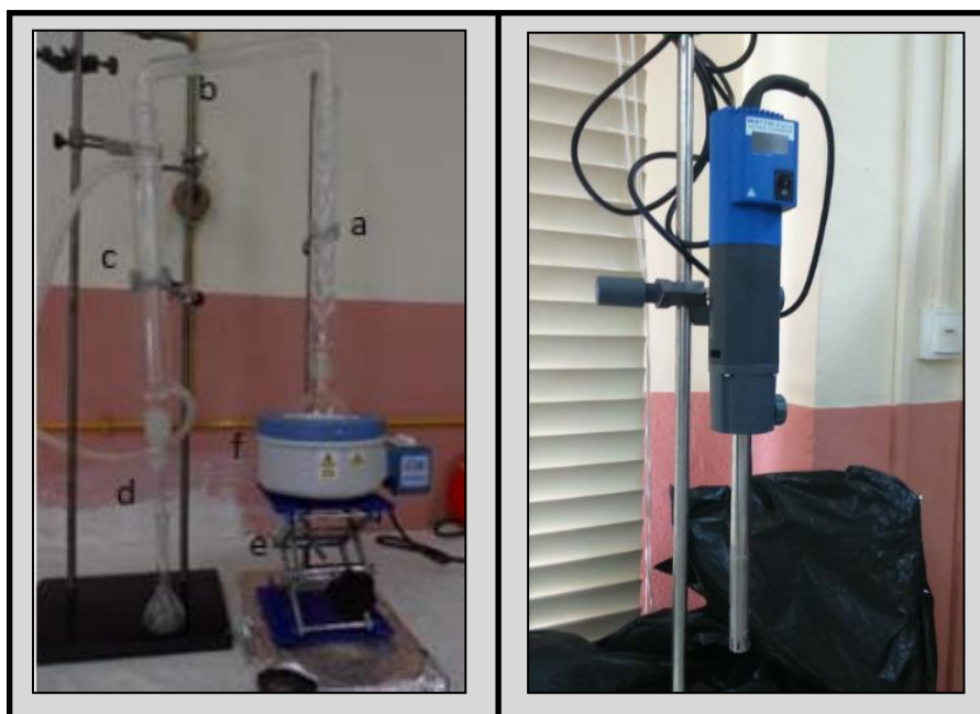
Figura 18. A la izquierda, sistema de destilación automática por arrastre de vapor: a) columna de rectificación, b) adaptador de destilación, c) tubo refrigerante, d) adaptador recto, e) elevador de laboratorio de 150x15 y f) Manta calefactora FIBROMAN-C. A la derecha, homogeneizador de alta velocidad ULTRA TURRAX (12000 rpm) con vástago incorporado.
