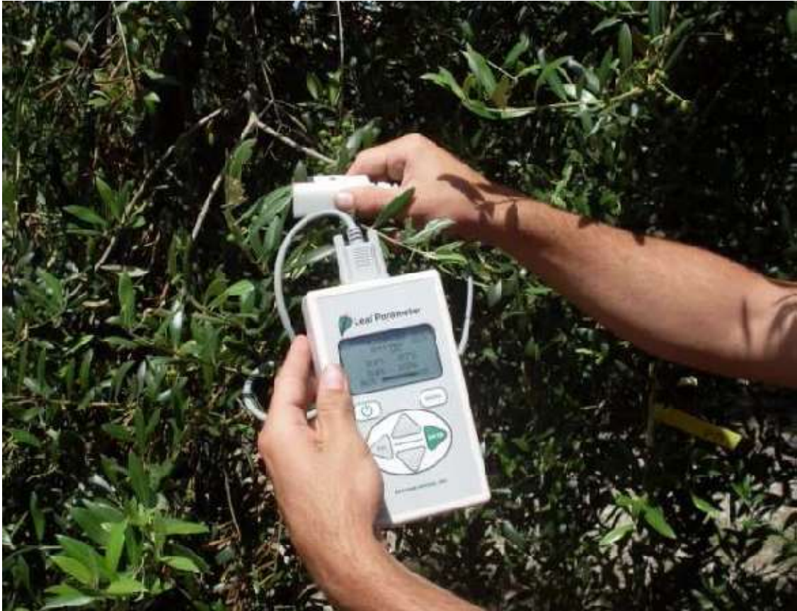
Imagen 10. Detalle del porómetro SC-1 en el momento que se está realizando una medición.
