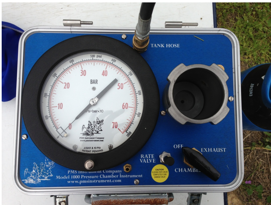
Imagen 9. Cámara de presión empleada para la medida de potencial hídrico de tallo.
