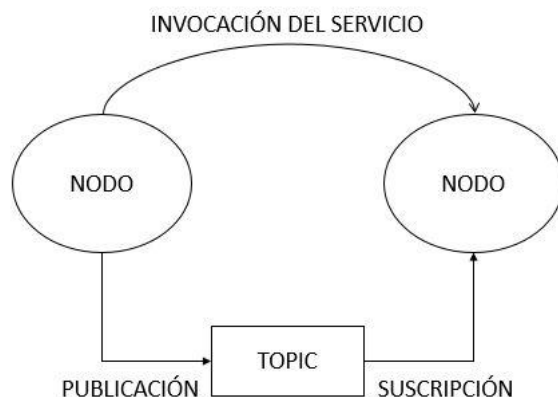
Figura 2.5 Esquema simplificado del funcionamiento de ROS
