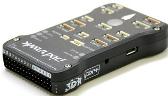
Figura 4.2 Autopiloto PX4 de Pixhawk
