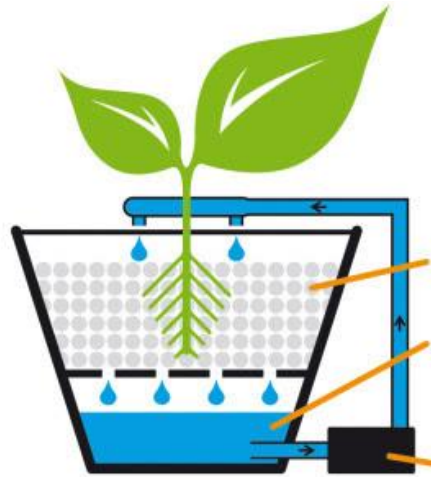
Sistema Hidropónico por goteo
