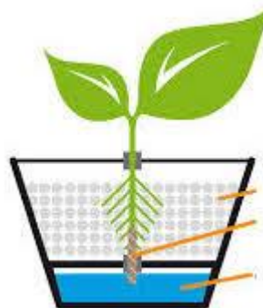
Sistema Hidropónico de Mecha
