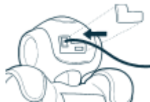
Ilustración 13 Conexión del Ethernet.
