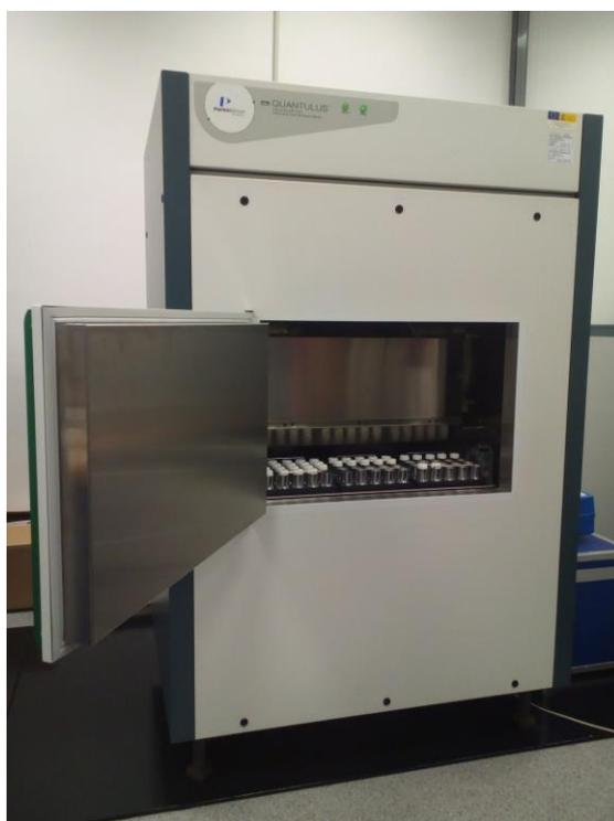
**Figura 3-2:** Espectrómetro Perkin Elmer 1220 Quantulus<sup>TM</sup>.
