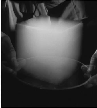
Figura 6: Apariencia de un aerogel a escala macroscópica. Referencia: Wikipedia
