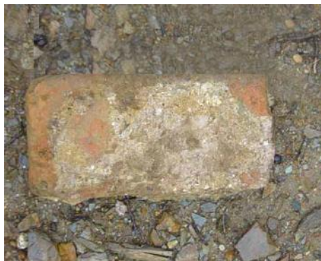
Ladrillo cerámico utilizado en el Arca del Agua, con restos del conglomerante, mortero de cal, en sus caras
