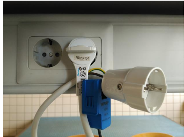
Ilustración 3.9. Montaje de sensor con adaptador
