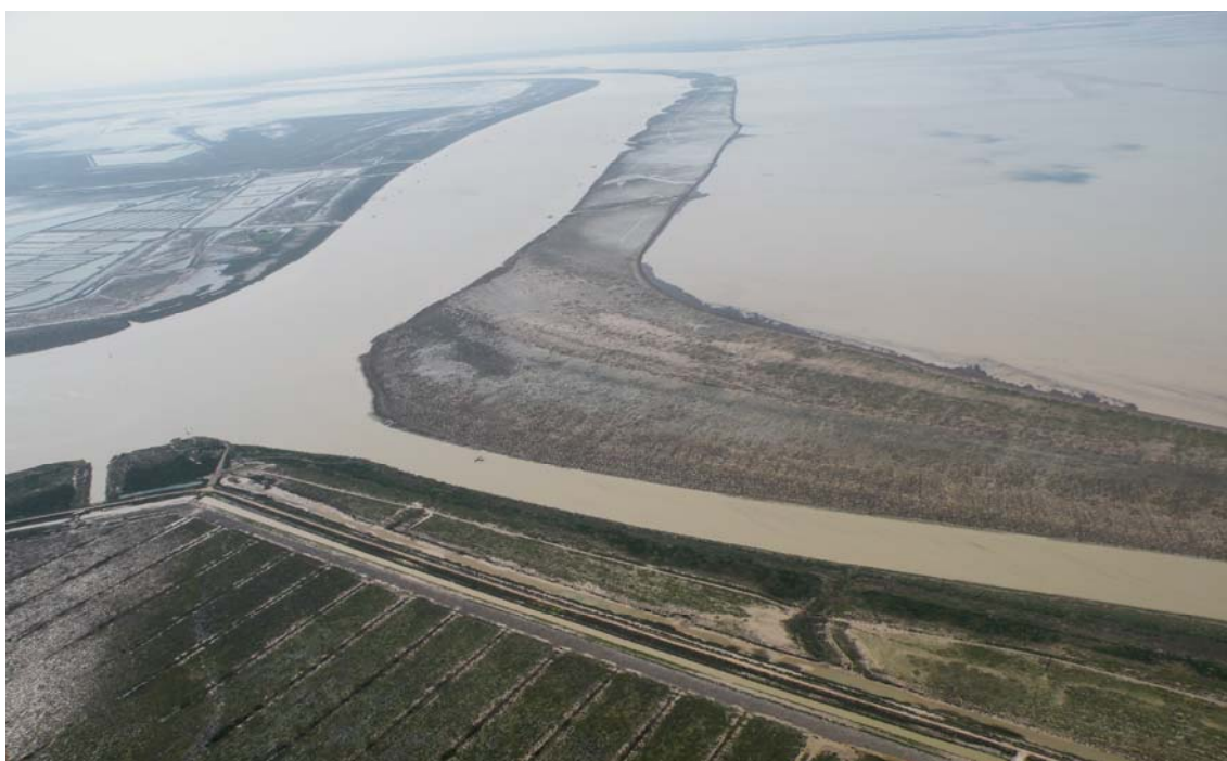
Figura 7. Perfil que muestra el efecto represa del Dique de la Montaña del Río, en las fotografía del 13/03/10 se observa la situación real de sobre-inundación y el efecto de presa que el dique ejerce sobre la marisma.
