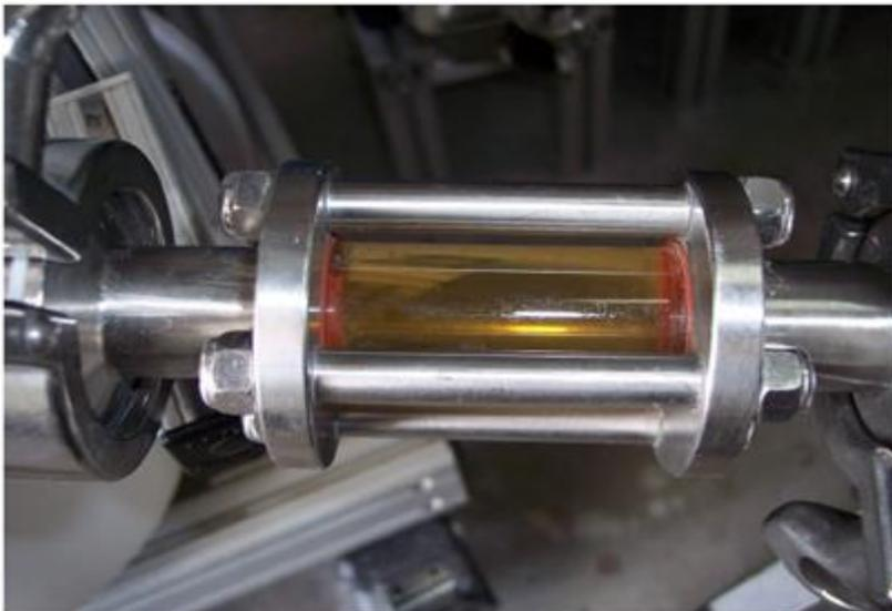
Figura 2-10 Mirilla de visión en el tanque de filtrado.
