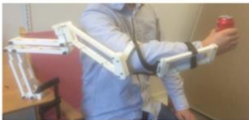
Figura24. Exoesqueleto fijado a un soporte fijo. Imagen obtenida de L. Zhou et al. (2017).
