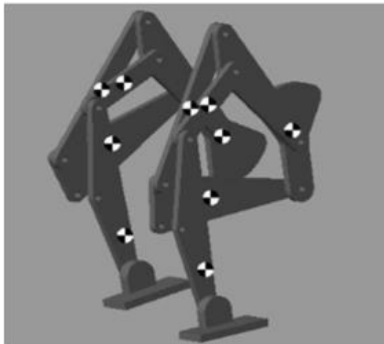
Figura4. Exoesqueleto pasivo de rehabilitación de las extremidades inferiores. Imagen de A. Singla et al. (2016)
