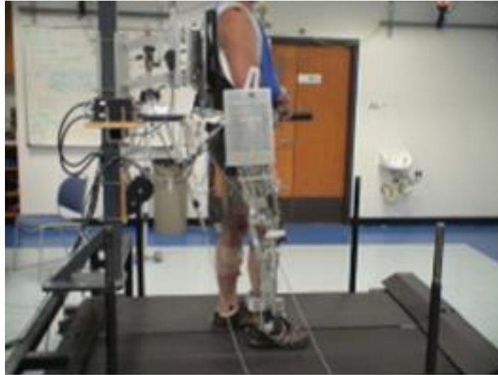
Figura26. Exoesqueleto acoplado a una cinta. Imagen obtenida de S. K. Agrawal et al. (2007)
