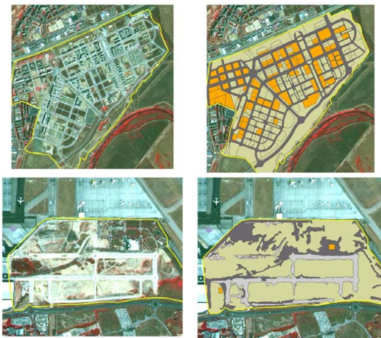
Figura 5. Ejemplos de Clasificación orientada a objetos con catastro adecuado (imagen superior) y no adecuado (imagen inferior), sobre imagen SPOT5 fusionada 2.5m.
