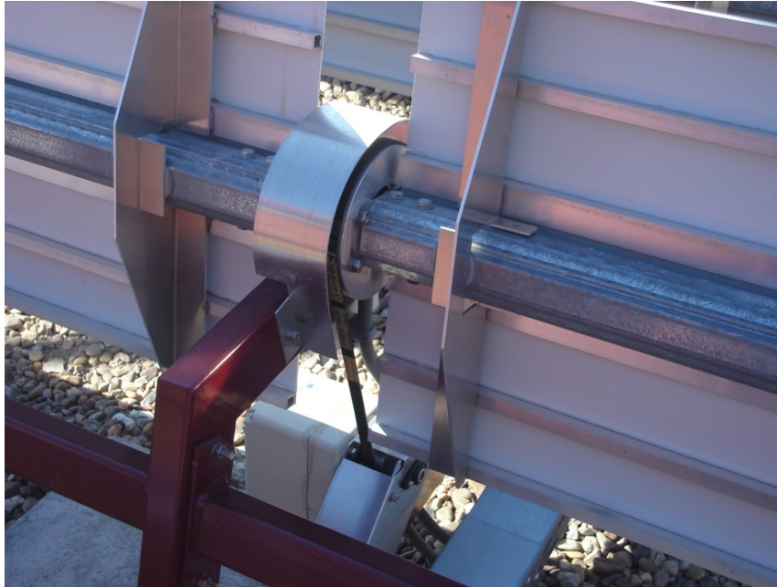
Figura 4-6 Mecanismo de arrastre de los espejos
