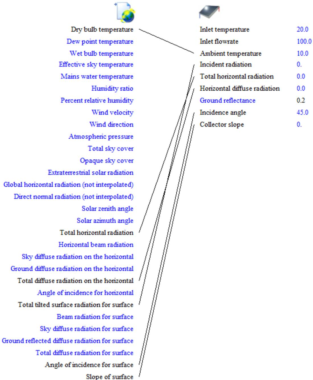
Figura 3-15 Ejemplo conexiones entre dos componentes en TRNSYS
