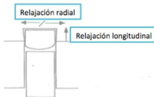
Figura 6. Recuperación elástica de un comprimido durante la eyección de la matriz (Vila Jato, 2001)
