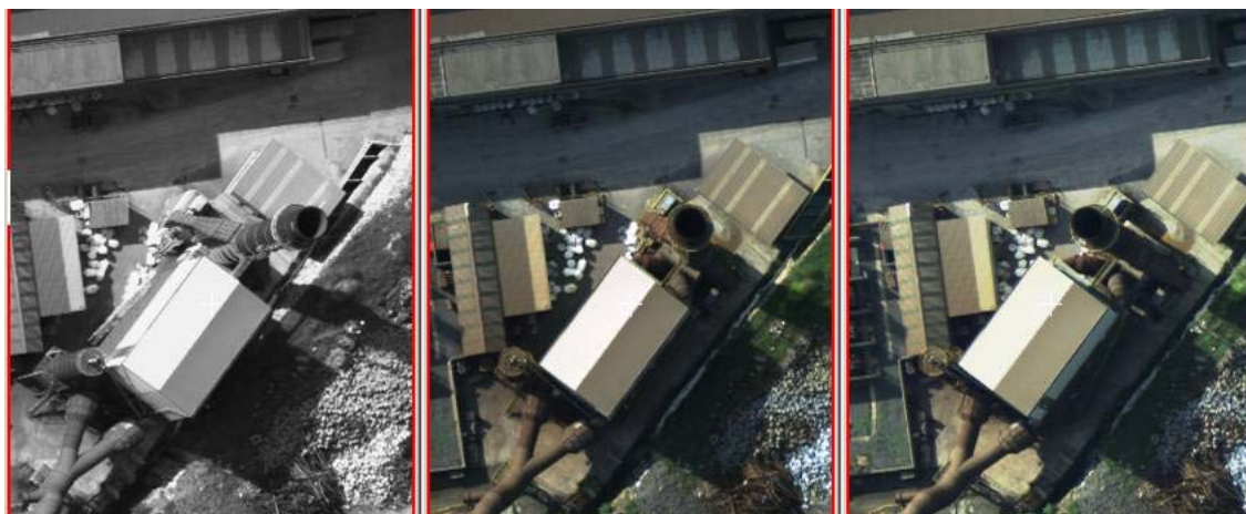
Figura 26. Ejemplo de diferentes vistas de un mismo objeto. De izquierda a derecha: vista forntal, nadiral y posterior. La imagen pertenece a un vuelo del núcleo urbano de Amurrio con GSD de 7 cm.
