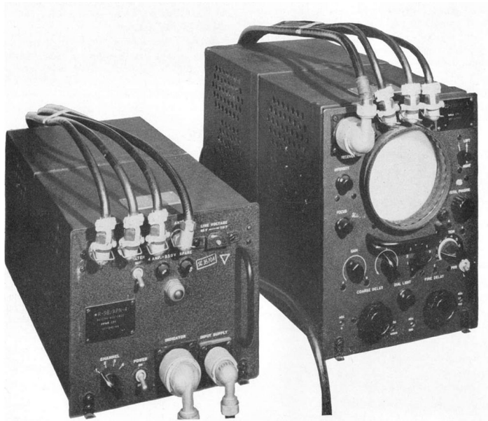
(a) Primer receptor Loran-C, modelo AN/APN-4 (Fuente: [18])
