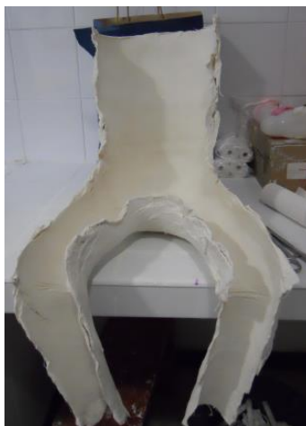
Figura 21: AM en escayola para pasar a material termoplástico.
