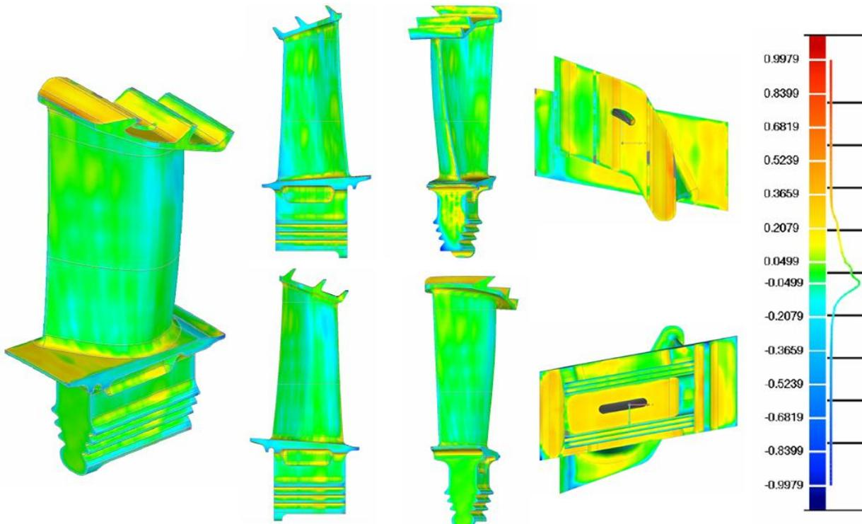
Figura 49. Análisis de desviación del prototipo II lijado (software del escáner).
