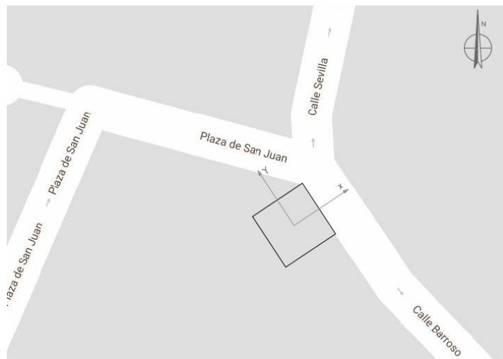
Figura 8. Orientación de los ejes de los acelerómetros en la ubicación del alminar.
