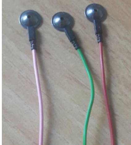
Figura 3.3 Electrodo pasivos sinterizados de Ag/AgCl
