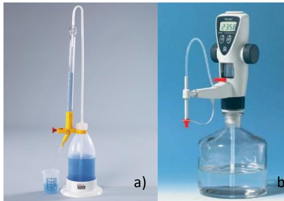
Figura 6. Buretas: a) de llenado automático y b) digitales.
