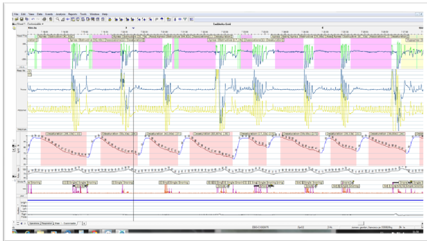
Figura 5: Registro de poligrafía respiratoria: monitorización de flujo oronasal (con sonda de presión y con termistor), esfuerzo torácico y abdominal (mediante dos bandas con sensores de esfuerzo), saturación arterial de oxígeno (mediante pulsioxímetro digital) y ronquido
