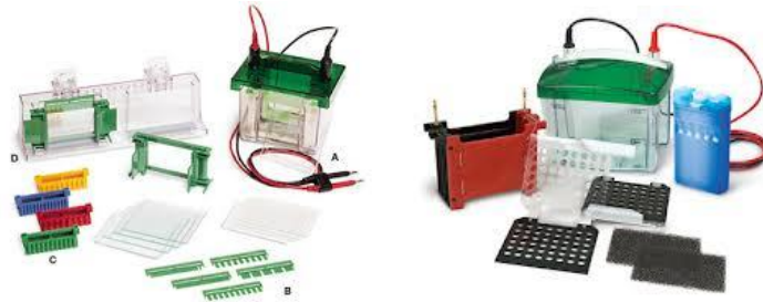
Figura 8. Equipo necesario para la realización de la técnica de Western blotting. Compuesto por sistemas de electroforesis y transferencia, y fuente de alimentación con electrodos, entre otros.
