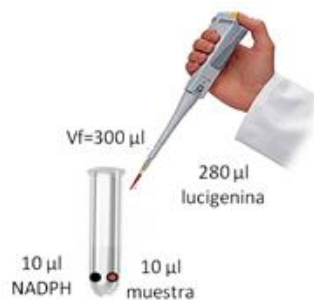
Figura 7. Determinación de la actividad NADPH oxidasa. La figura muestra la disposición del sustrato y la muestra en el tubo de poliestireno antes de iniciar la reacción mediante la adición de la lucigenina.
