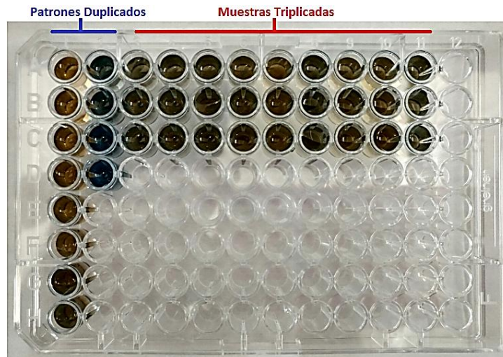
Figura 6. Determinación de la concentración de proteínas mediante el método de Bradford. Ejemplo de microplaca ELISA completada para colocar en el lector de datos del ordenador.
