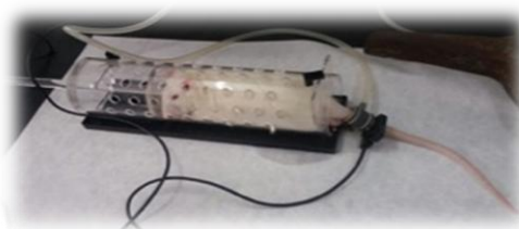
Figura 3. Medidas de la presión arterial en ratas. Se utiliza un cepo especialmente diseñado para inmovilizar al animal, y se introduce el manguito y el transductor en la cola del mismo para recoger la señal de pulsos.
