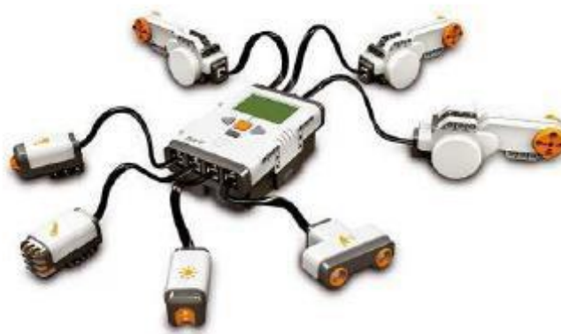
Figura 7: Bloque NXT con sensores y actuadores
