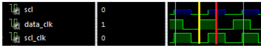
Ilustración 20 "Data_clk" y "scl_clk" desfasados 1/4 de ciclo
