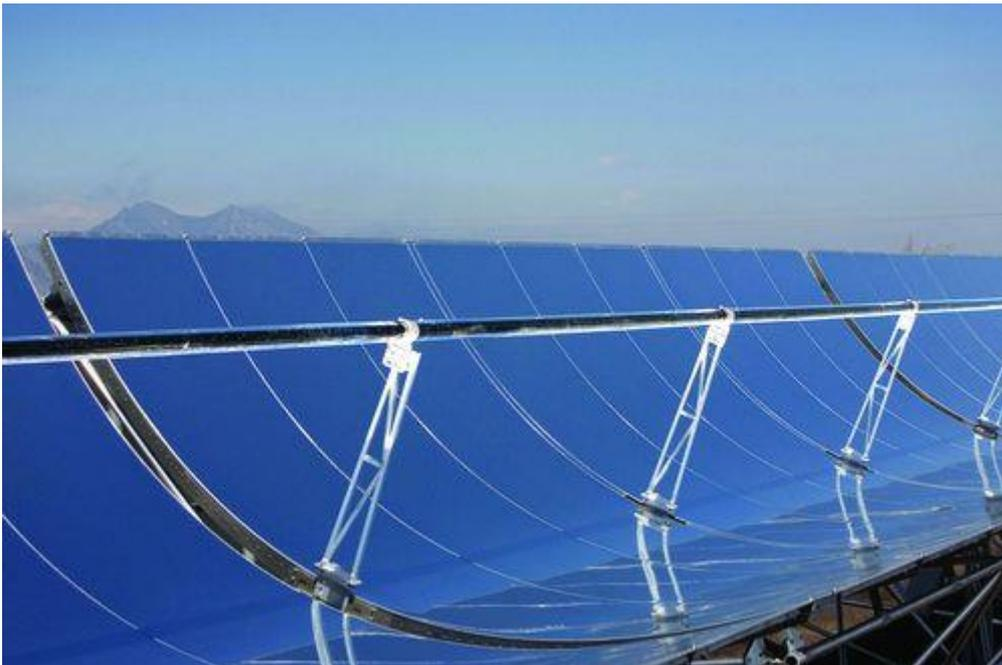
*Ilustración 47: Reflector cilindro-parabólico y tubo receptor de una central termosolar. [6]*
