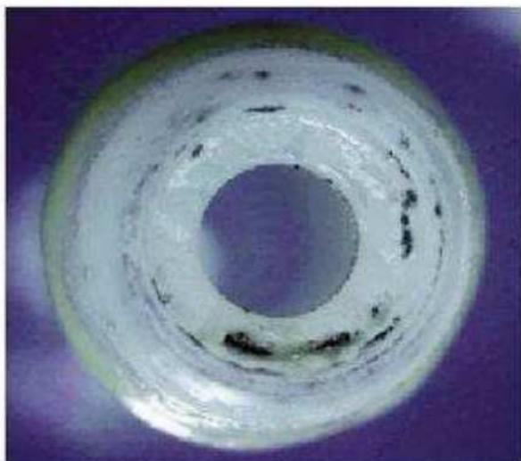
Figura 6. El sistema de conexión interna recubierto IR falló por desprendimiento de la interfaz de titanio
