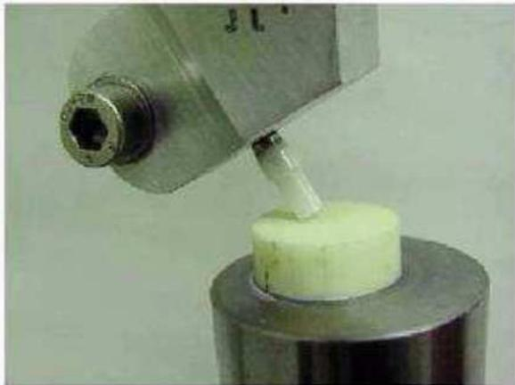
Figura 3. Montaje experimental para los ensayos mecánicos. El desplazamiento del pistón es vertical
