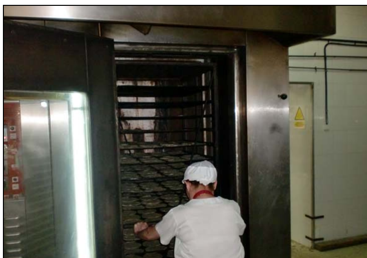
Foto 22. Carga de armario de tortas en horno estático
