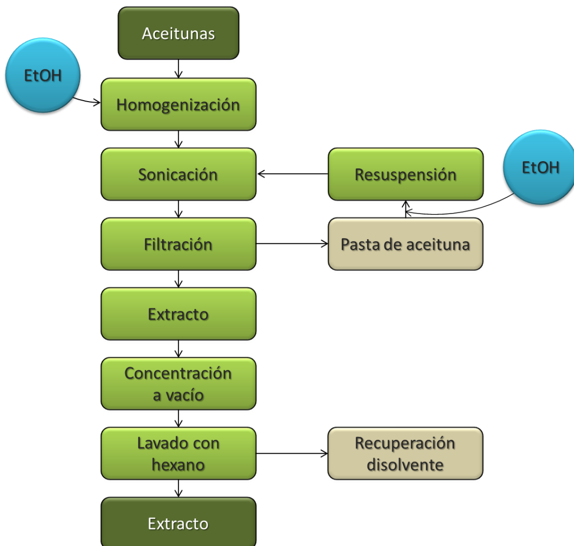
Figura 8. Esquema de preparación del extracto etanólico de la aceituna mediante el segundo método.
