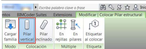
Figura 6.29. Comando colocar pilar vertical
