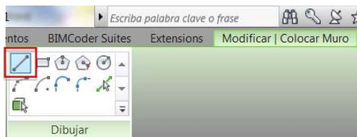
Figura 6.20. Comando línea para Crear trazado de muro
