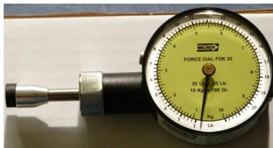
**Figura 16.** Algómetro marca WAGNER INSTRUMENTS; Modelo FORCE DIAL FDK 20
