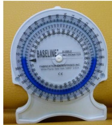
**Figura 17.** Inclinómetro de burbuja BASELINE, marca CHATTANOOGA
