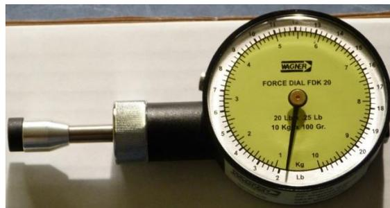
**Figura 16.** Algómetro marca WAGNER INSTRUMENTS; Modelo FORCE DIAL FDK 20
