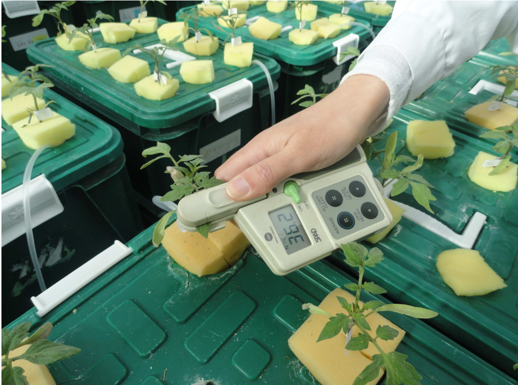
Figura 10. Evaluación de la concentración total de clorofila en hoja con el dispositivo SPAD-502 de Chlorophyll Meter (Minolta Camera Co., Osaka, Japón).
