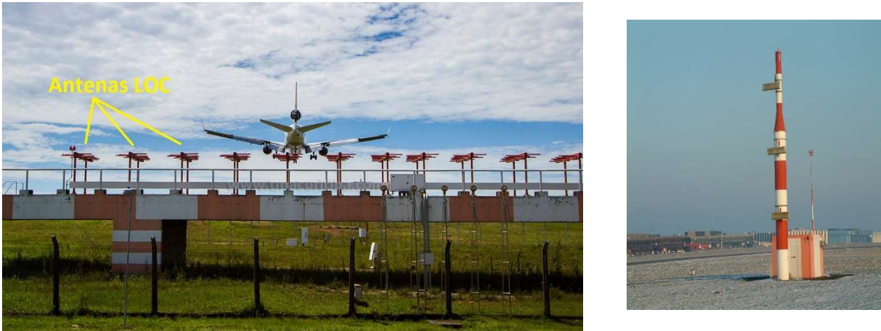
Figura 2.1. Antenas ILS – Localizador (izquierda) y Senda de planeo (derecha).
