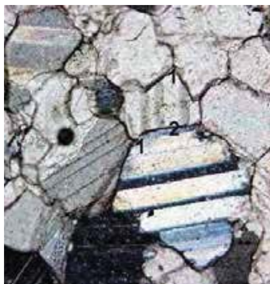
Figura 4. Izquierda, aspecto microscópico general donde se observa la textura de recrystalización que caracteriza a esta muestra del mármol y la relativa homogeneidad en el tamaño de los cristales. Derecha, puntos de unión triples entre cristales de calcita (1) y límites intercrystalinos rectos (2).
