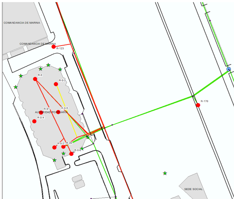
Ilustración 5-5. Conexiones de nodos, las líneas verdes son fibra óptica multimodo, verdes monomodo y amarillo cable de telefonía
