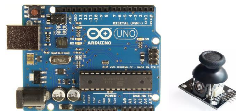
Figura 3: A la izquierda, microcontrolador Arduino; a la derecha, joystick analógico utilizado.
