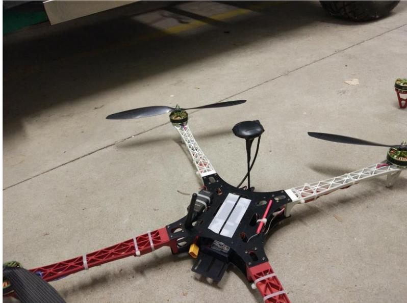
Ilustración 4-25 Quadrotor con el GPS instalado
