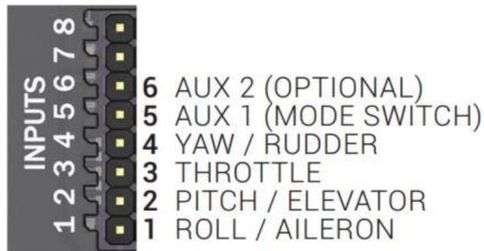
Ilustración 4-22 Conexionado Inputs del receptor
