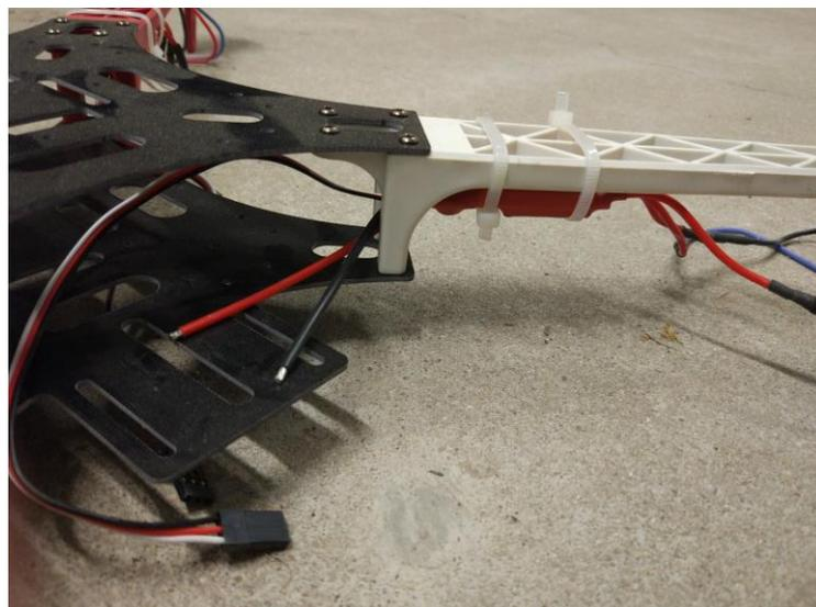
Ilustración 4-16 Regulador instalado con bridas
