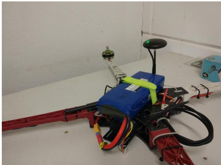
Ilustración 4-26 Quadrotor con la Batería instalada en la bandeja superior
