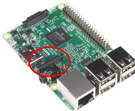
Ilustración 4-12 Ranura para la Conexión de la Picamera V2
