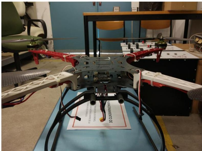
Ilustración 4-20 Instalación de la placa controladora (APM)
