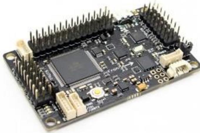
Ilustración 4-6 APM HkMega 2.7 sin carcasa protectora
