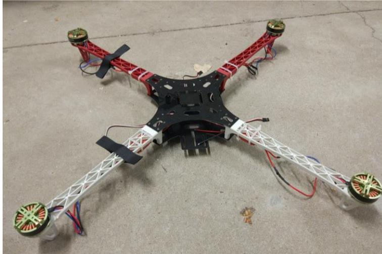
Ilustración 4-17 Dron con Motores y Reguladores
