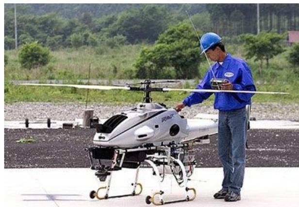
Ilustración 3-15 Operador manipulando un Yamaha Rmax
