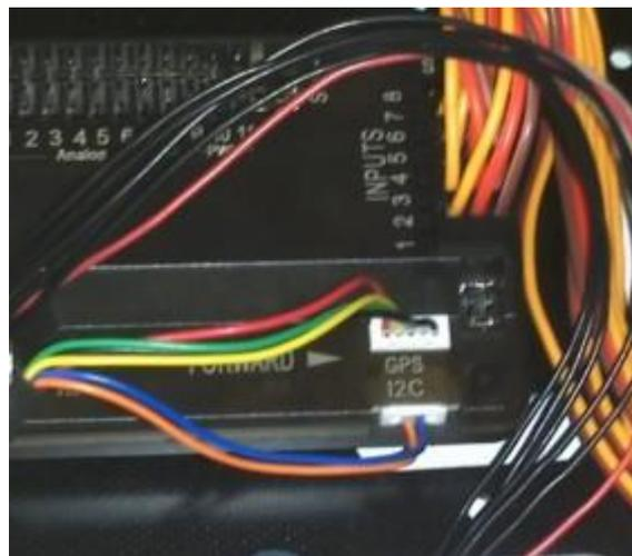
Ilustración 4-24 Conexión GPS y Magnetómetro
