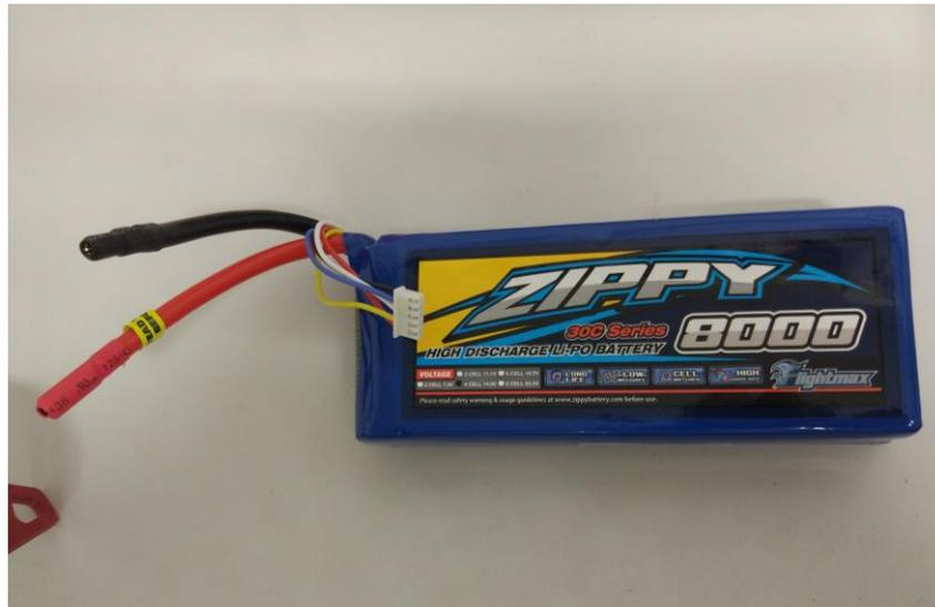
Ilustración 4-9 Batería Zippy 8000 mAh
