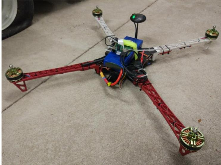
Ilustración 4-29 Montaje final del Quadrotor
