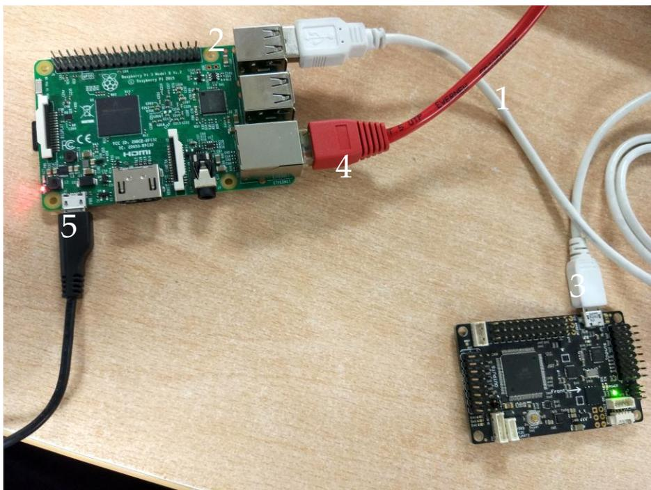
Ilustración 4-48 Conexionado V2 Rpi-APM
