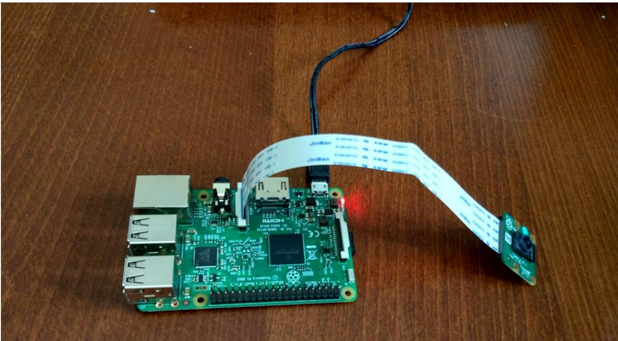
Ilustración 4-51 Conexión de Rpi-Cámara V2
