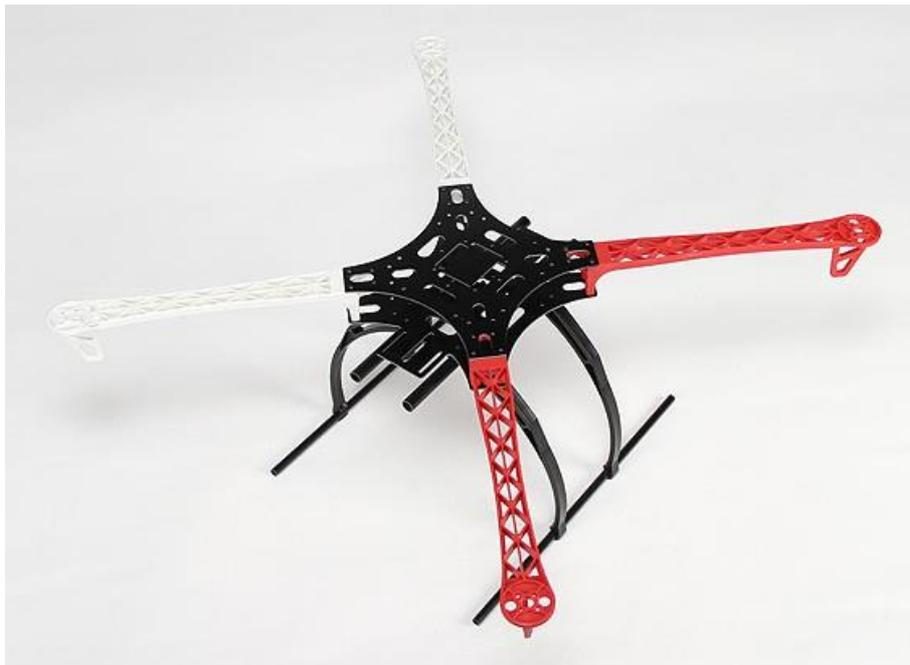
Ilustración 4-2 *Frame* ensamblado con las patas
