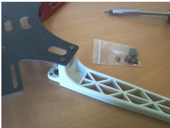
Ilustración 4-14 Ensamblaje del piso inferior del Chasis
