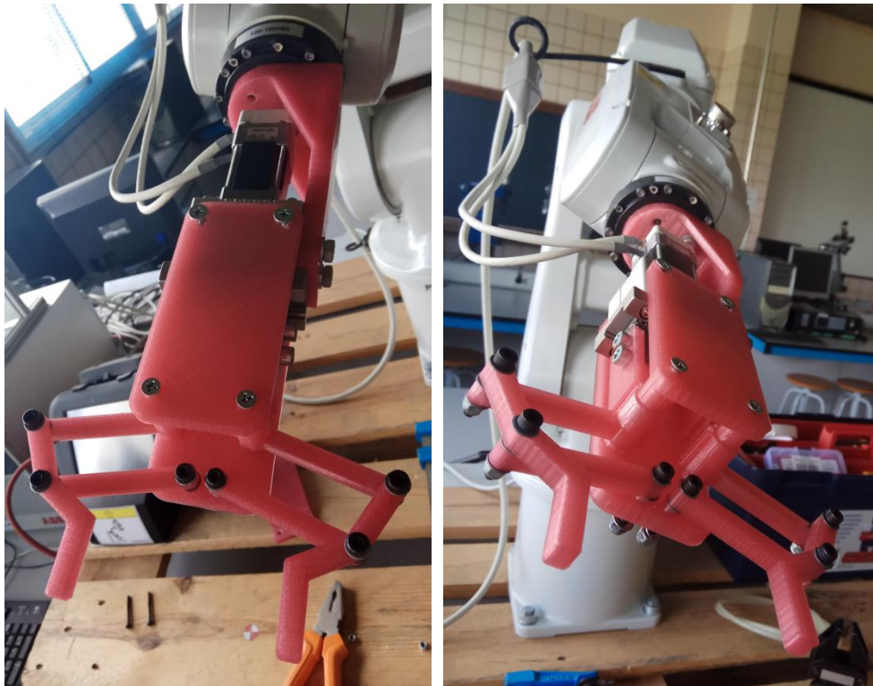
Figura 29: Conjunto pinza y garra articulada abierta instalado en IRB120
