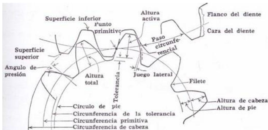
Figura 13: Elementos de un piñón
