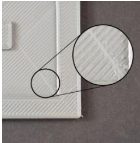
Figura 100: Surcos o estriado en la última capa de la impresión
