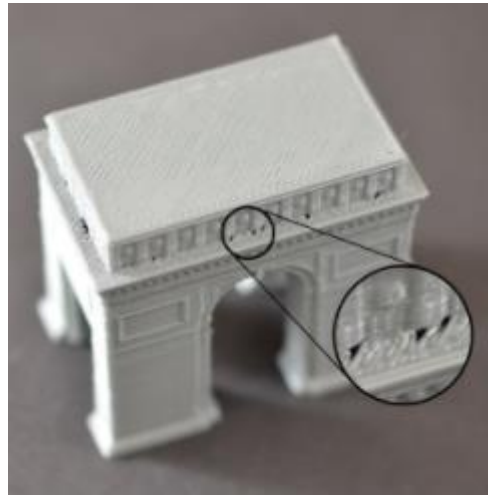
Figura 101: Huecos horizontales en esquinas rentrantes
