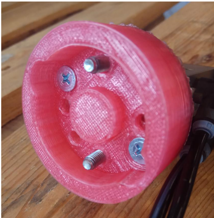
Figura 71: Unión impresa y montada pinza paralela – IRB120
