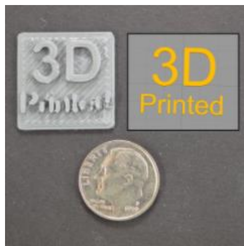
Figura 105: No se imprimen los pequeños detalles
