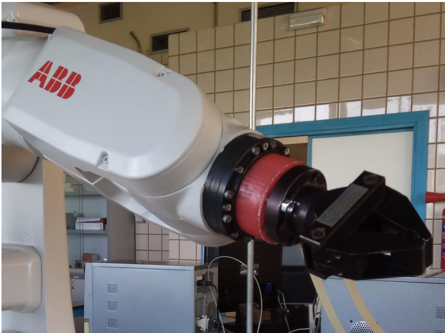
Figura 69: Unión impresa y montada pinza angular – IRB120
