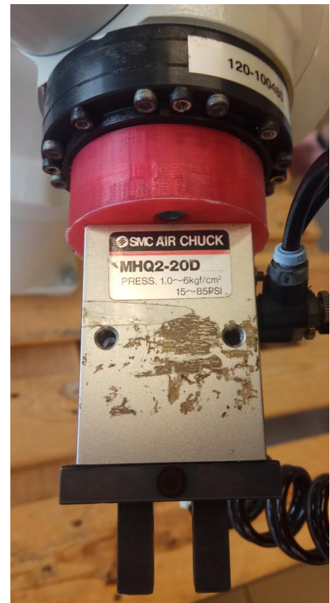
Figura 71: Unión impresa y montada pinza paralela – IRB120
