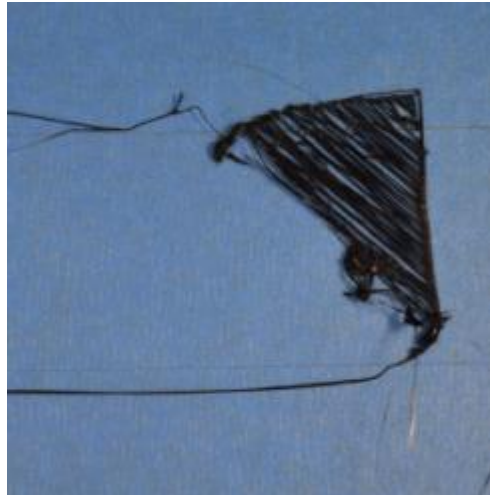
Figura 85: Falta de adhesión a la cama
