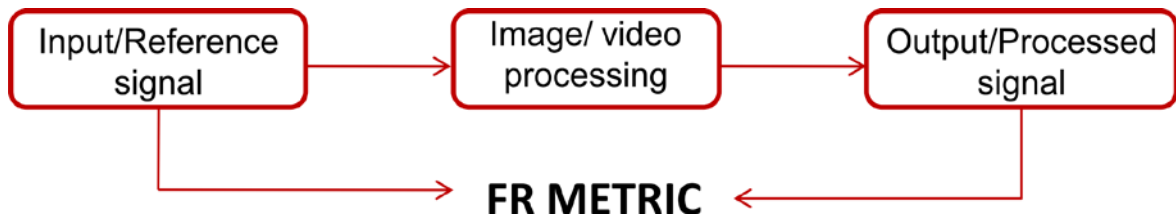
Figura 1: Diagrama de métodos Full Reference
