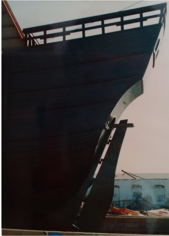
Figura 6.59. Detalle del timón
