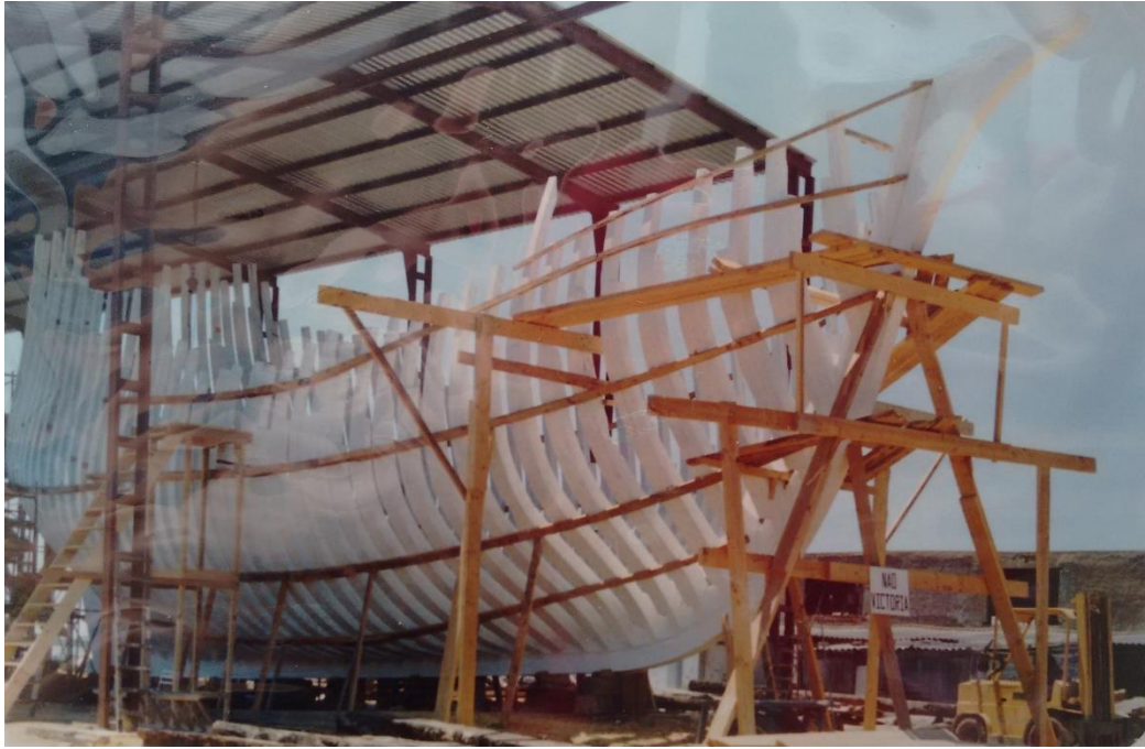
Figura 6.27. Estructura interna en los astilleros
