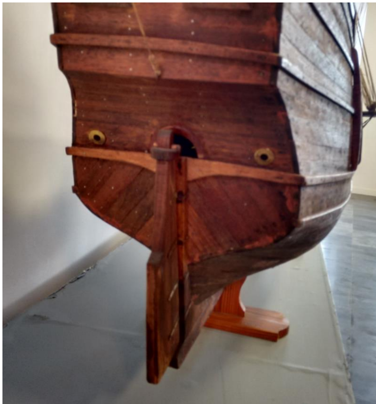
Figura 6.60. Detalle del timón en la maqueta
