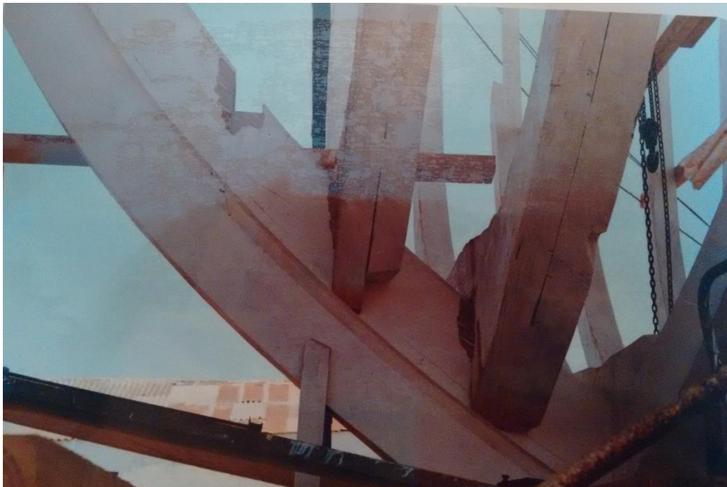
Figura 6.18. Unión real de las cuadernas en el pie de roda
