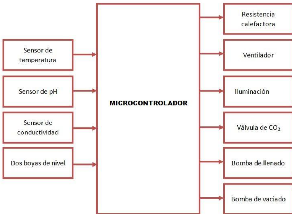
Figura 5-1. Entradas y salidas al microcontrolador
