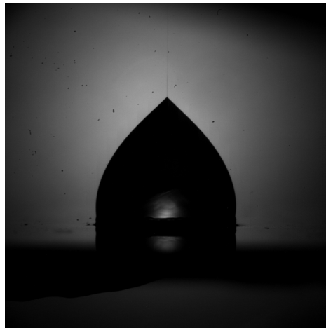
Figura 4.6 Emisión de chorro cargado de una gota de etilenglicol conectada a 8,5kV.
